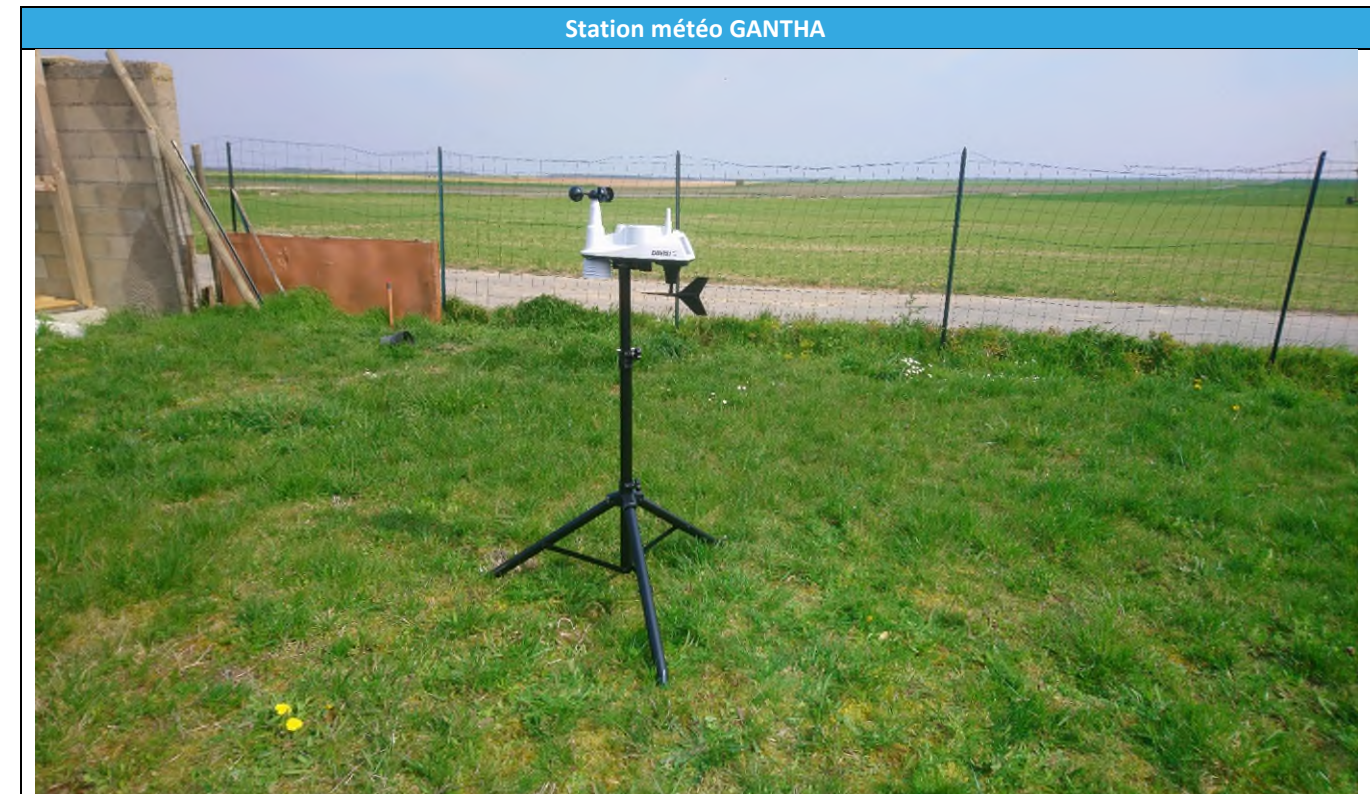
Figure 290 : Station météorologique à 1,5 m
